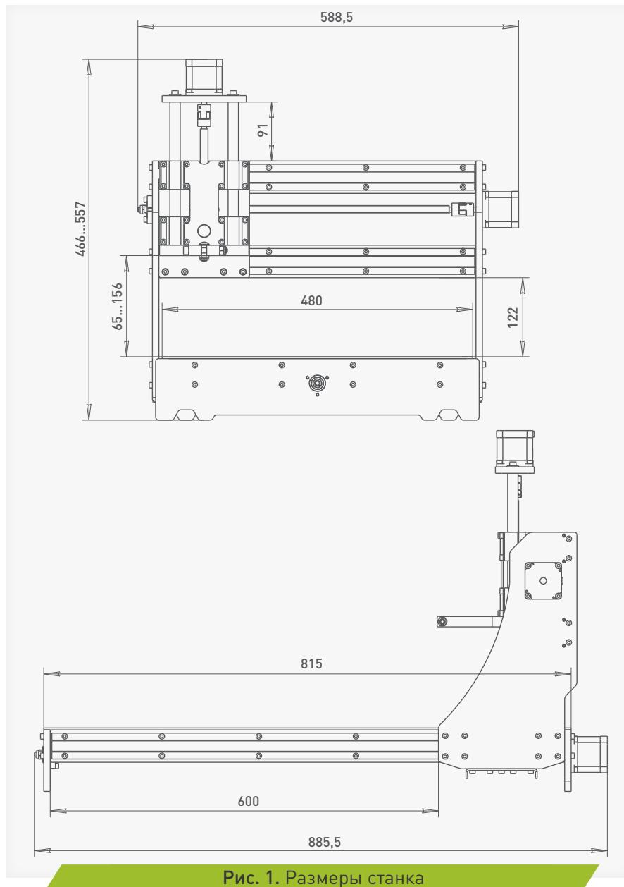
Рис. 1. Размеры станка
