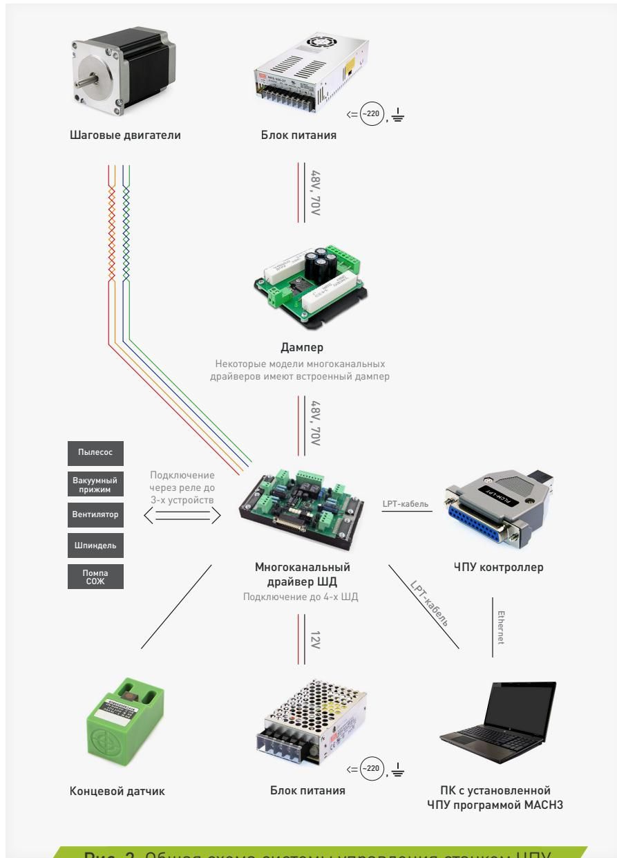
Рис. 2. Общая схема системы управления станком ЧПУ
